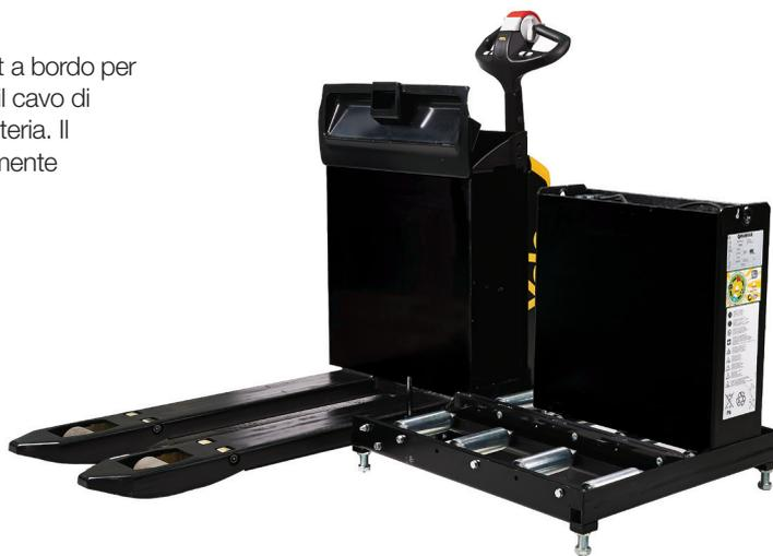
Estrazione laterale della batteria:
