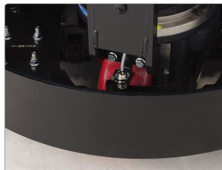
Il sensore Yale Smart Slow Down™ rileva automaticamente significativi cambi di direzione e regola di conseguenza la velocità del carrello.
